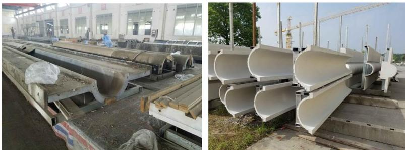
新型绿色外墙系统 GRC 幕墙安装，引用 BIM 技术指导施工，满足建筑设计师结构安全和设计构思的要求。在外墙系统 GRC 幕墙生产中，首先对钢结构和条形凹凸面造型进行深化设计，利用 BIM 技术三维建模的方法，对条形凹凸面造型和钢结构构件布置由生产厂家进行优化及一体化生产，指导 GRC 制造厂采取合理有效的加工工艺，提高施工质量和效率，降低施工难度和风险。
