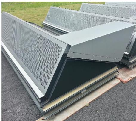
在加工前由设计、生产、质检部门联合，层层交底的方式，逐步落实剖析组装单元所有技术要求、组装方式、顺序、合理性等，逐步简化生产流程，使之更易单元板块组装。组装时，按照加工图将每种材料逐一编号，拍照并形成图片板。单元板块组装时看板，解剖单元组装流程，制作单元组装流程图，分步骤依次有序进行。
