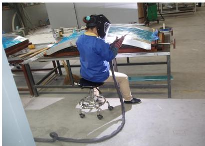
⑥打磨：焊接部位及轻微划伤表面，需打磨均匀。目测无钉痕、无损伤、打磨均匀、圆角一致。
