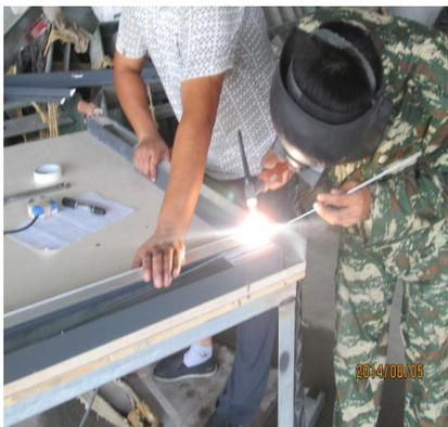
连接部分的内腔的表面和型材的断面部分保持一定的湿度。将尺寸、平整度做最后确认，进行焊接。
