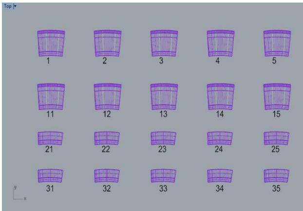
根据实际加工条件分割出合理的模数，编号下单，使用全站仪指导安装施工，现场安装对号入座。
