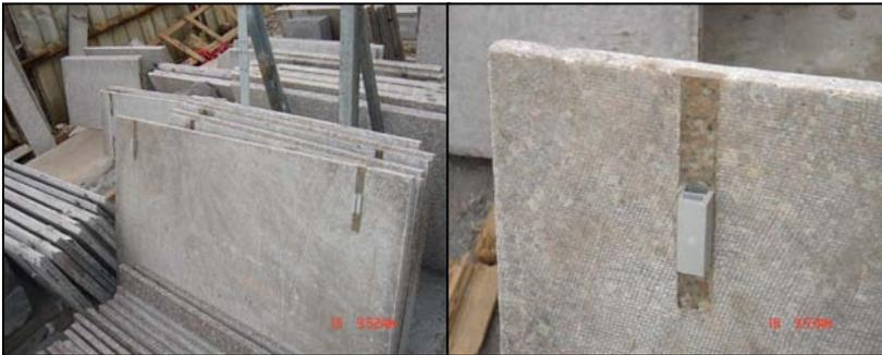
图 3-34 石板背面加粘玻璃纤维织物
